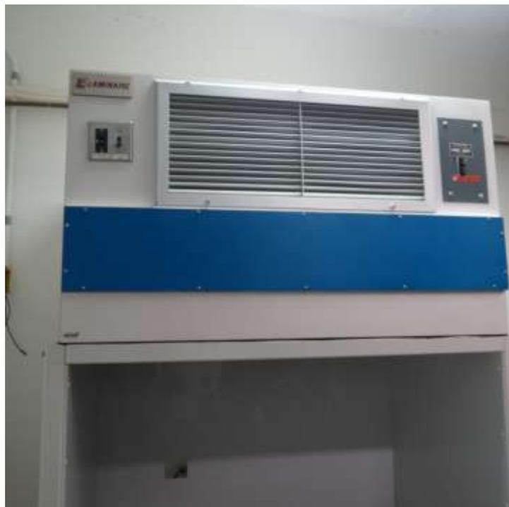
Figura 3 - Fluxo laminar para preparação de substratos - classe 100
