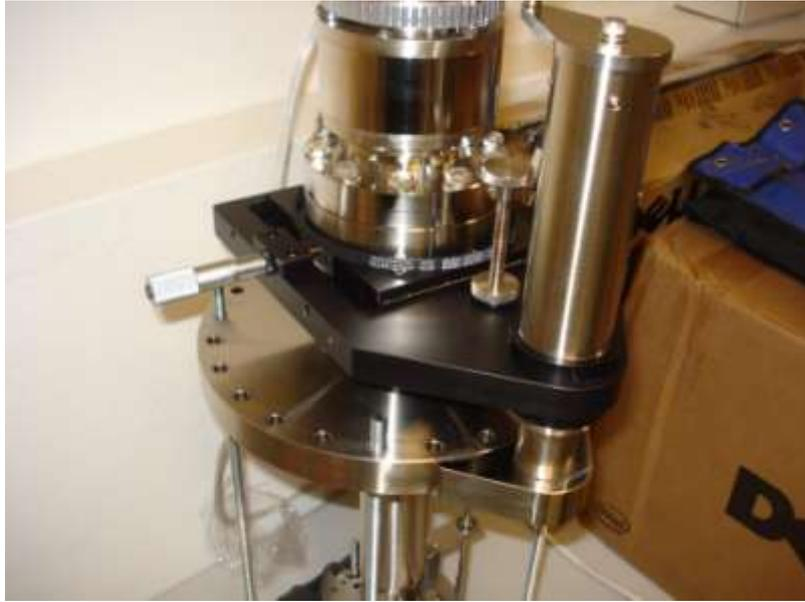
Figura 8 - Manipulador de substratos
