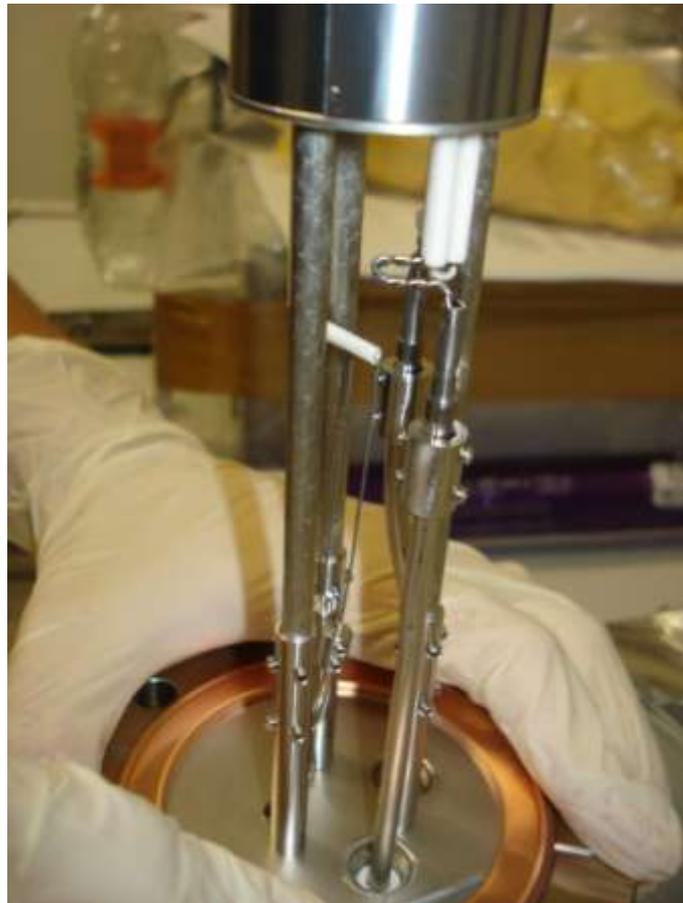
Figura 9 - Detalhe de uma célula de efusão
